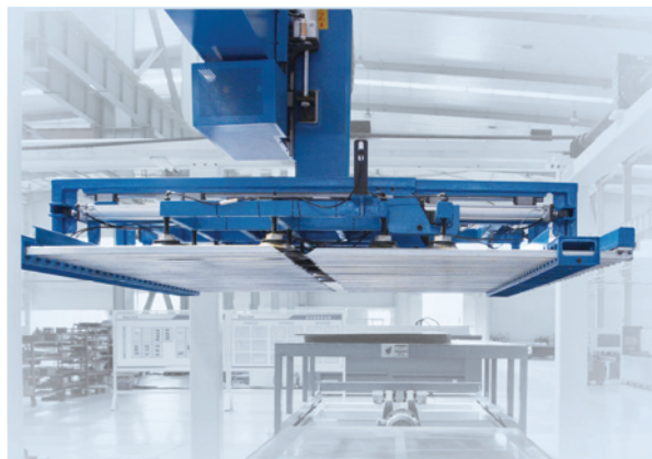
自动上下料装置（上料吸盘机构 / 下料指状托料架） Sucking device for loading / finger support for unloading
